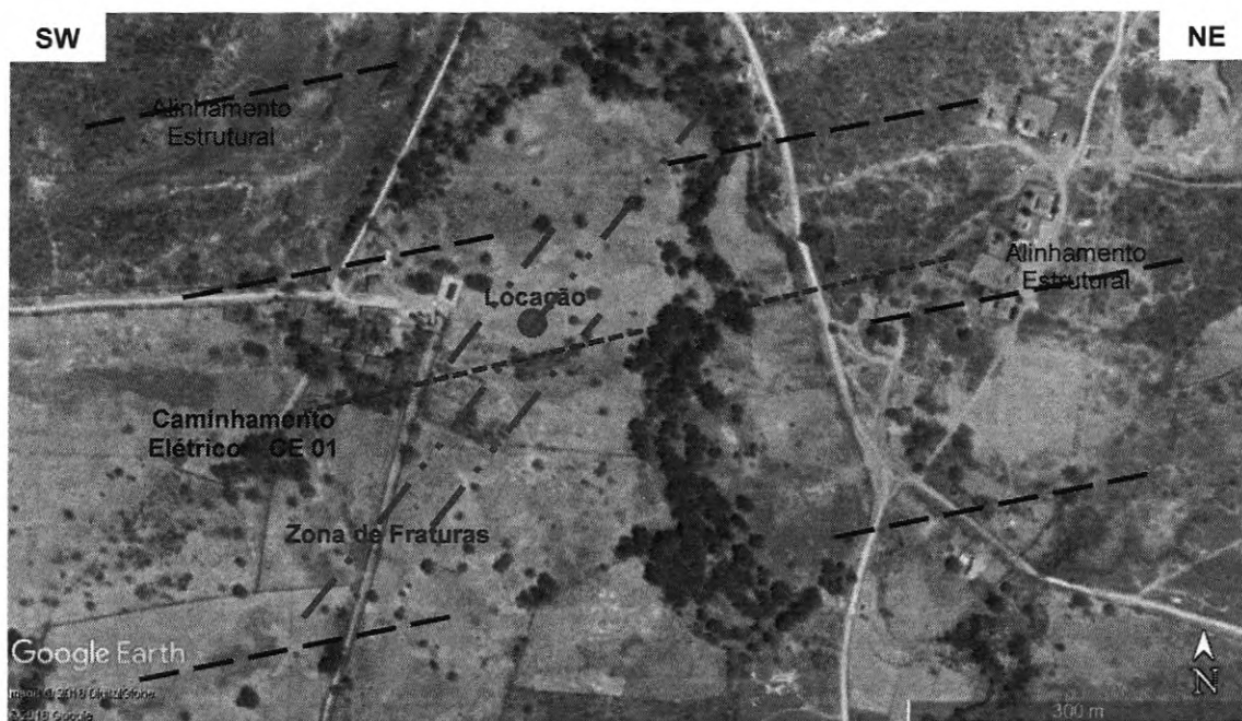
Figura 02 – Imagem de distribuição espacial do Caminhamento Elétrico CE 01, Comunidade de Cachoeira – Irauçuba/CE.
