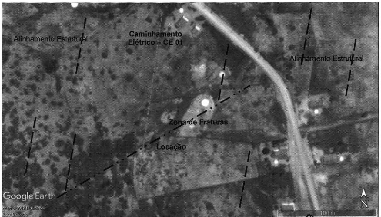
Figura 02 – Imagem de distribuição espacial do Caminhamento Elétrico CE 01, Assentamento Rodeador, Distrito de Juá – Irauçuba/CE.
