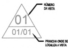
INDICAÇÃO DE FACHADA
