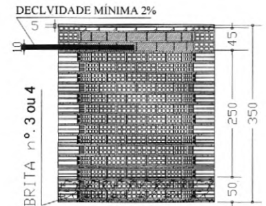
CORTE EE SUMIDOURO Esc.: 1:100
