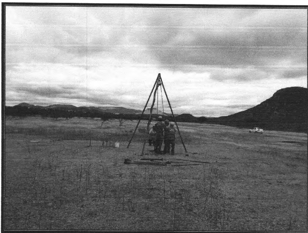
FOTO 2 – EQUIPE EXECUTANDO UMA SONDAGEM SPT.
