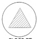
BLOCO DE ANCORAGEM
