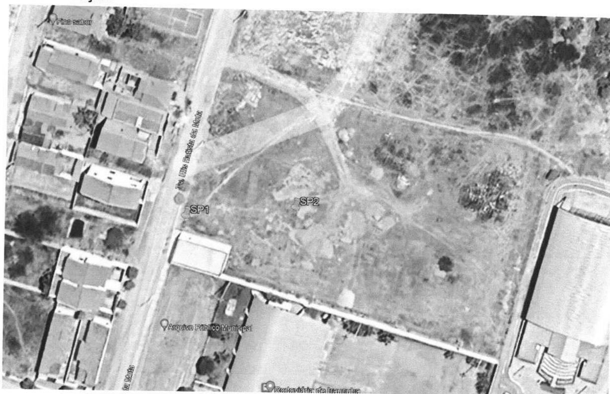
Foto 01: Localização das sondagens realizadas na Rua José Ari Ramos Filho, ao lado do Terminal Rodoviário.
