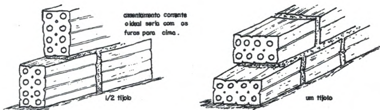
Figura 1 - Execução de alvenaria utilizando tijolos furados.
